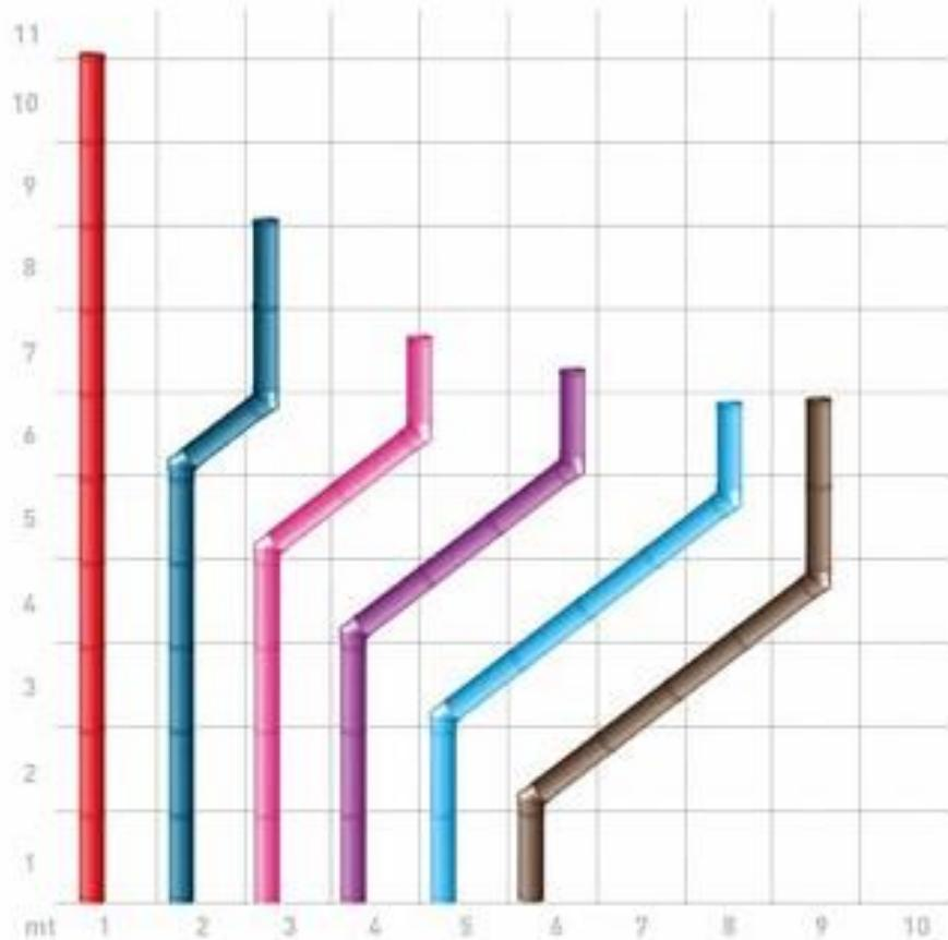
Solo per alcuni modelli sarà necessario smontare i deflettori presenti all'interno della camera di combustione. È obbligatorio installare, al termine del tratto orizzontale, un adeguato terminale di scarico. Tale elemento deve agevolare l'uscita dei gas di scarico ed al contempo minimizzare l'azione di venti contrari. È fondamentale che i gas incombusi non vengano ripescati dal condotto aspirazione aria.
